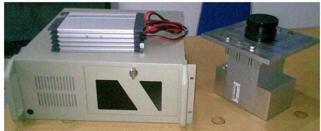
Gambar 4. Kamera CCD-baris LISAT-EM3 (kanan) dan komputer pengendali (kiri).
